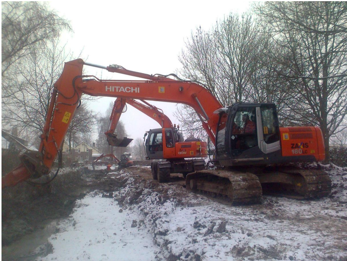
Afbeelding 3: Van voor naar achteren een Rupskraan, een bandenkraan/mobiele kraan en een mini rupskraan van Firma Basten. 3
