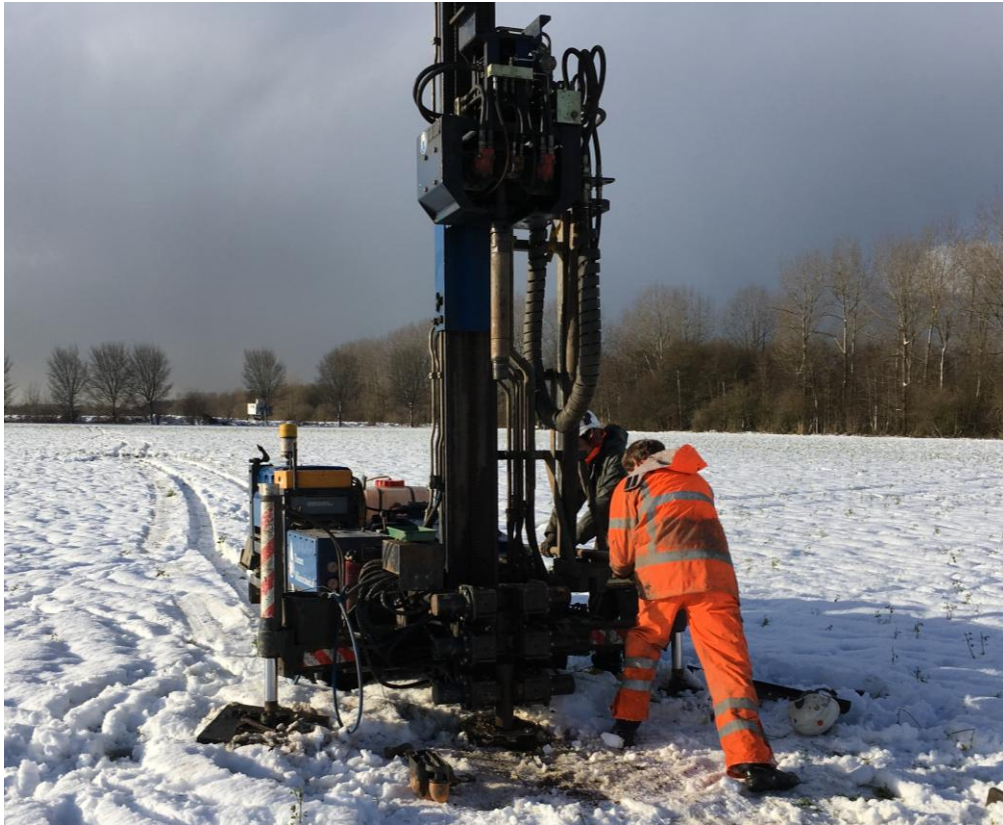
Afbeelding 5: Sonische boormachine van Daemen in actie in het veld in Almere.
